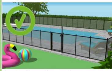
Bien qu'amovible, cette clôture est solidement ancrée au sol.
