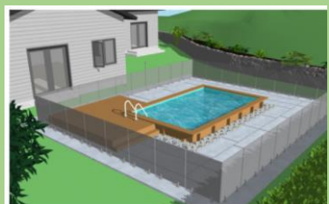
Une enceinte doit être installée à plus de 1 m d'une fenêtre susceptible de permettre à un enfant d'accéder à l'intérieur de celle-ci.
